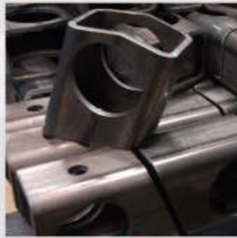
Corte de Tubos
