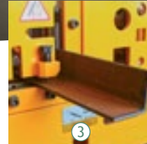
3 Köşebent kesme istasyonu Angle cutting station Rezka уголка
