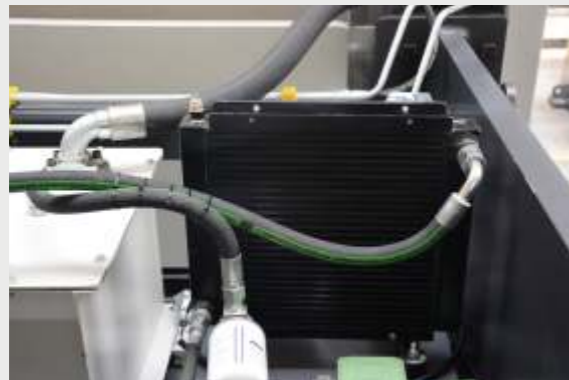
Sistema de Refrigerador de Aceite Hidráulico
