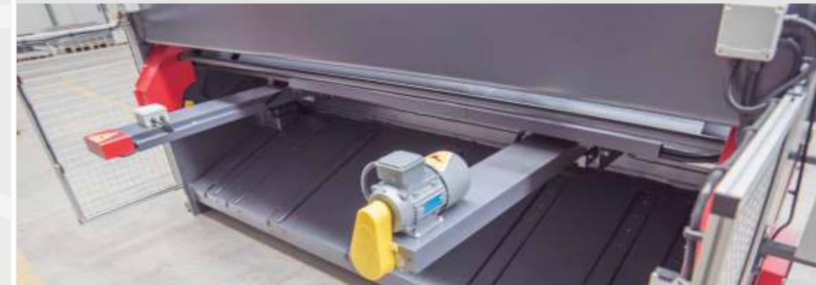
Tope Trasero Motorizado con una Precisión de \pm 0,1 mm
